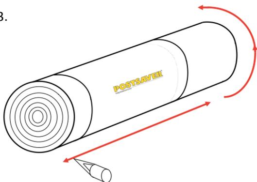
3. Utilisez la pointe de la flamme de la torche pour rétracter la gaine sur le poteau. Chauffez la gaine jusqu'à ce qu'elle soit complètement rétractée.
